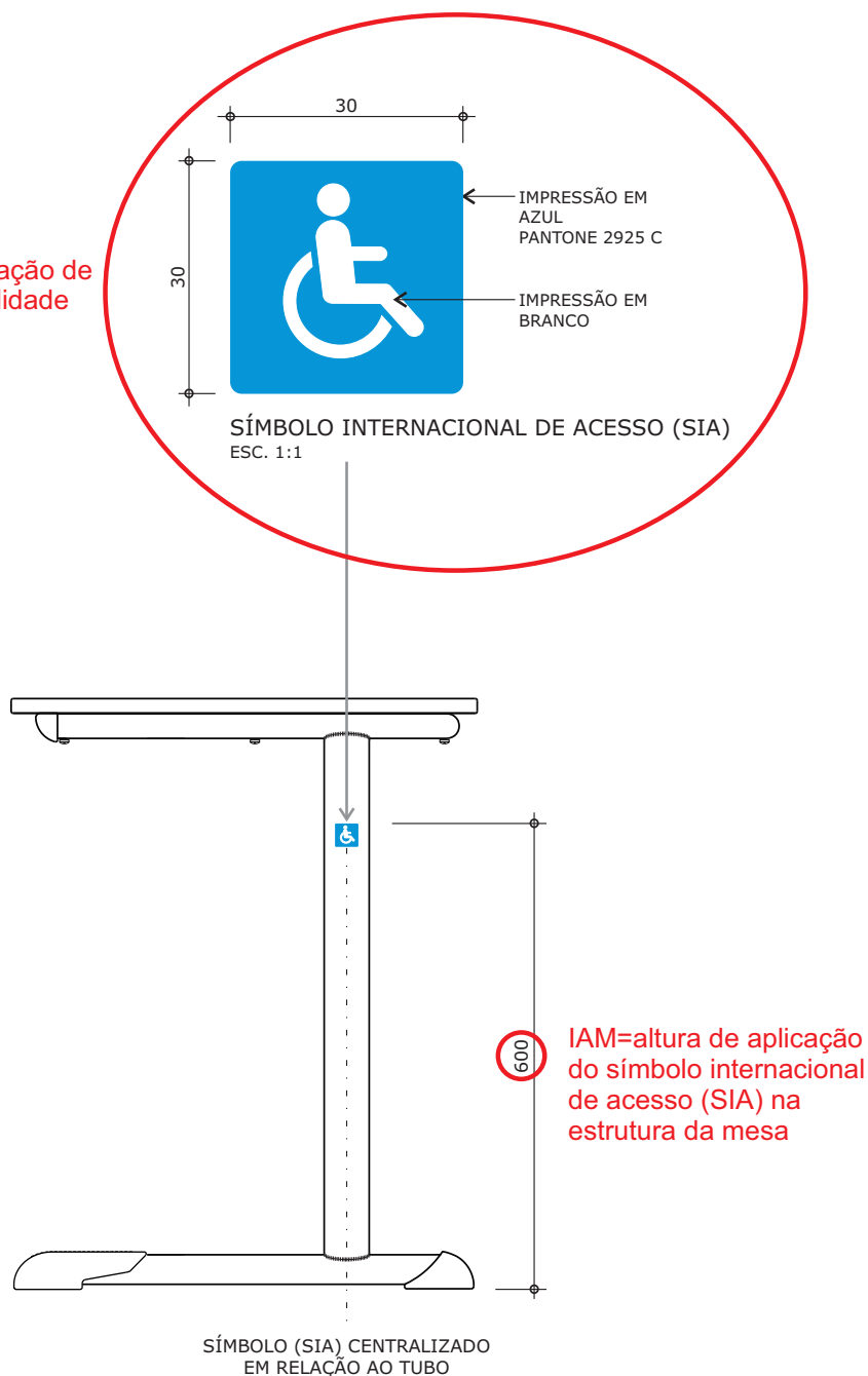
APLICAÇÃO DA INDICAÇÃO DE ACESSIBILIDADE VISTA LATERAL DIREITA DA MESA ESC. 1:10
